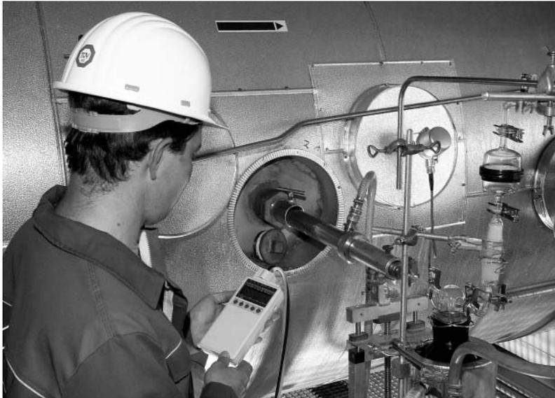
Abbildung 1: Emissionsmessung von Dioxinen
